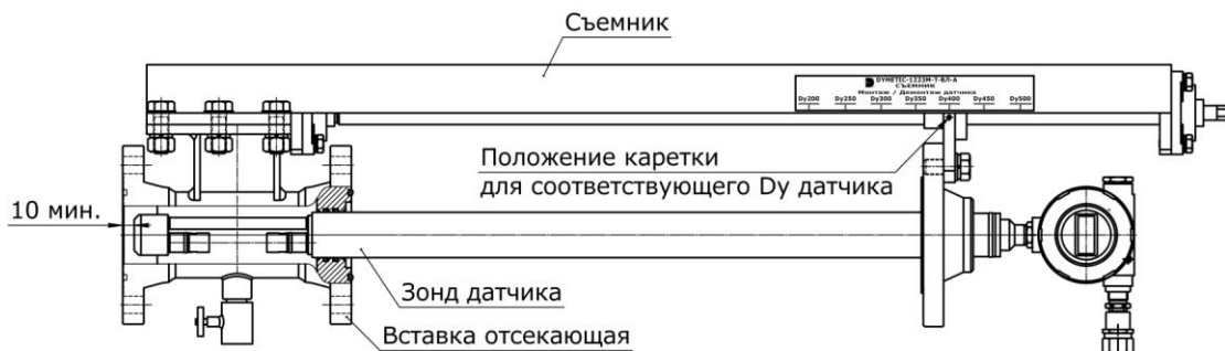
Рисунок 22. Установка положения зонда датчика
