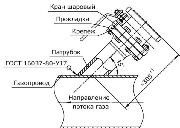
Рисунок 19. Установка крана шарового датчика исполнения «ВЛ»
