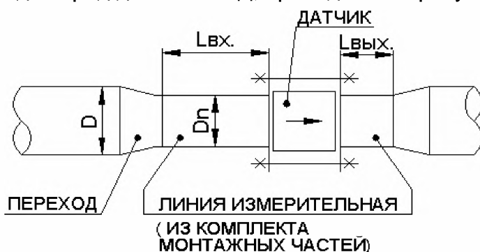
Рисунок 1 Установка датчика МД в трубопровод большего D_y
